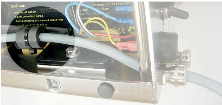
**TÄRKEÄÄ:** P-LIGHT® on typpihyväksytty ECE No. 10 mukaisesti. Sääntö edellyttää että syöttöjohto liittimille 3-7 asennetaan mukana seuraavan ferriittirenkaan läpi, kts. kuva.
