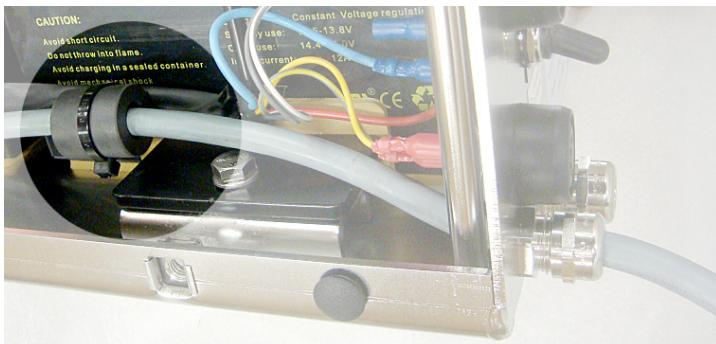
**VIKTIGT:** P-LIGHT® är typgodkänd enligt ECE No. 10. För att detta ska gälla måste inkommende kabel som kopplas till plint nr 3-7 monteras genom bipackad ferritkärna, se bild.
