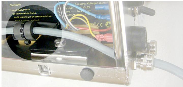
**WICHTIG:** P-LIGHT® verfügt über eine Bauartgenehmigung nach ECE Nr. 10. Damit diese gilt, müssen eingehende Kabel, die an Klemme Nr. 3-7 angeschlossen werden, mit dem mitgelieferten Ferritkern montiert werden (siehe Bild).
